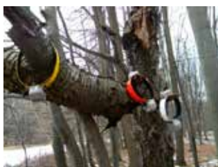
Obr. 3 a,b GPS satelitný telemetrický vysielač (obojok) na medveďa a testovanie týchto vysielačov
